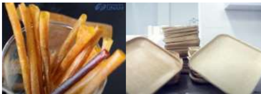
Figura 6. Bioplásticos a base de materiales vegetales. A la izquierda: Popotes de cáscara de mango (UNAM, 2020). Al centro: lámina de almidón de palta (LABVA Biomateriales, 2020). A la derecha: Platos a base de harina de yuca (Universidad del Cauca, 2016).
